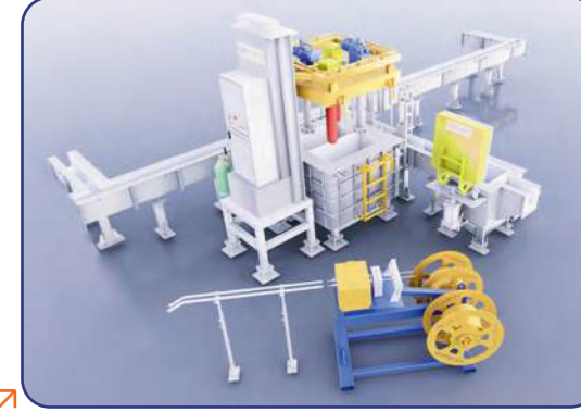
Seramik Filtre Ünitesi, AlTiB Besleyici, Gaz Alma Ünitesi Ceramic Filter Unit, AlTiB Feeder, Degassing Unit
